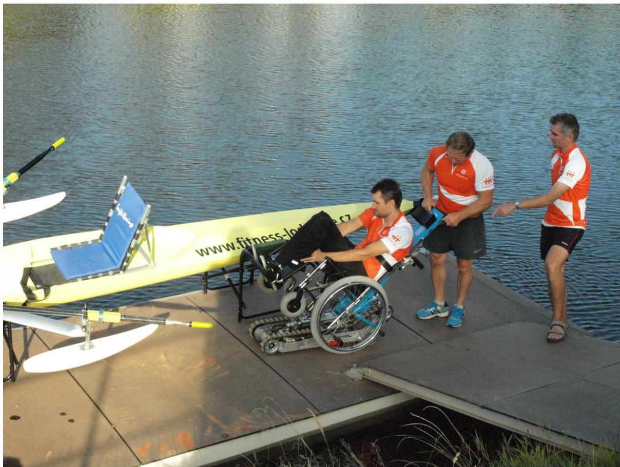
Kompenzační pomůcka – schodolez pro sportovce s tělesným postižením
